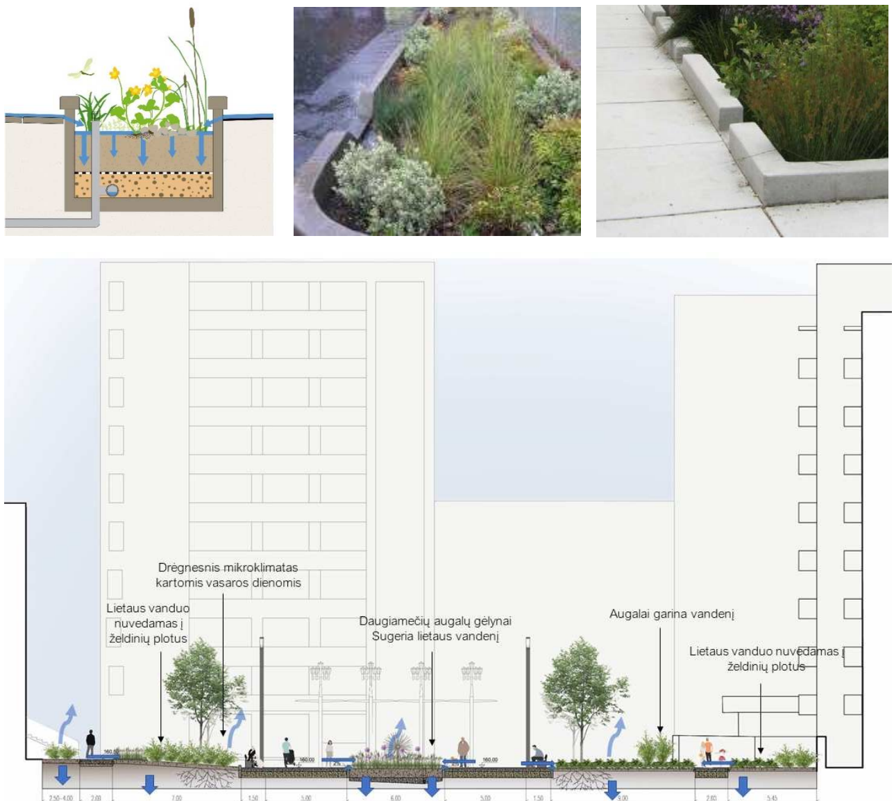
Lietaus vandens surinkimo želdinių zonose principinė schema
